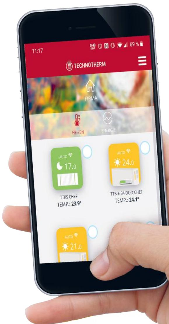
Die Speicherheizung vom Typ TTB-E Duo mit statischer Wärme-Emission sind ideal als Heizgerät für viele Arten von Räumen. Ein Wärmespeicher der neuen Generation mit internetfähigem Thermostat. Er misst die Raumtemperatur und entscheidet über die Dauer der Ladung.
