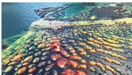
Die Frontplatte mit dem 2.5D-Druck (siehe Seite 90 für mehr Informationen) hat einen haptischen Effekt und wurde mit 17 verschiedenen Schichten mit einem speziellen UV-Lack bedruckt.
