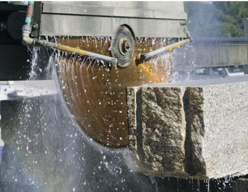
◀ Unsere **TECHNOTHERM** Natursteinheizungen werden aus Natursteinblöcken unterschiedlicher Länder hergestellt. Die tonnenschweren Blöcke werden in sogenannten Gattersägen zu einem „handlichen“ Maß vorgeschnitten.
